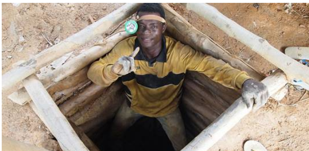
Figura 8. Un minero ghanés en la apertura de un pozo de mina de 15 m reforzado con madera.
