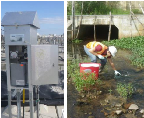
Thiết bị lấy mẫu không khí (Ảnh: TerraTherm) | Lấy mẫu ở cửa xả Hồ Sen (Ảnh: CDM Smith)
