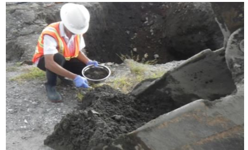
Lấy mẫu đất để xác nhận lớp đất bên dưới của hệ thống xử lý là đất sạch. (Ảnh: CDM Smith)
