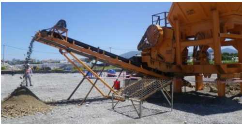
Xử lý bê tông bằng máy nghiền (Ảnh: CDM Smith)
